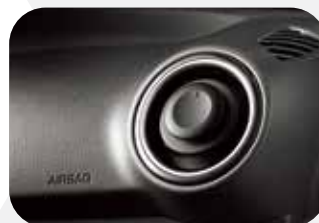
Conduits d'air pivotant à 360°
